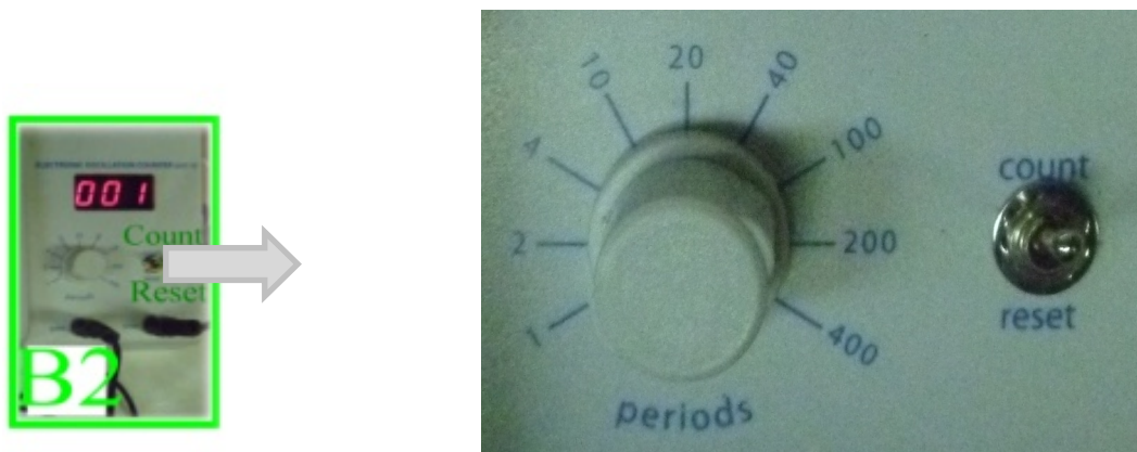
Σχήμα 4β: Επιλογές στον απεριθμητή περιόδων. Θέση διακόπτη: από την τιμή του n=100 . (Θέση Count: ON)
