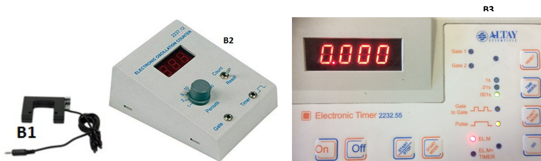
Σχήμα 4α: Τα 3 βασικά όργανα, που συνιστούν τη διάταξη μέτρησης προεπιλεγμένου αριθμού ταλαντώσεων.
